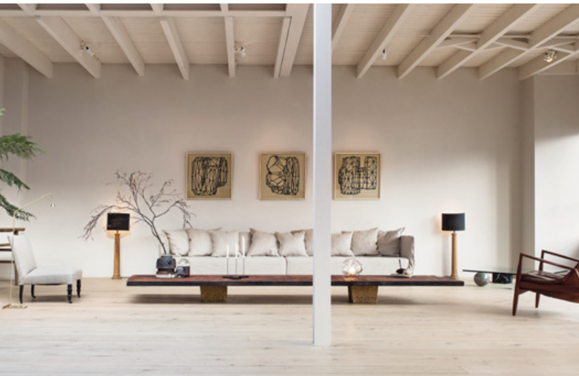
3 Silikatfarben, wie bei „The LOFT“ in Amsterdam, sind wohngesund, weil konservierungsmittelfrei und diffusionsfähig. Foto: entertheloft.com
