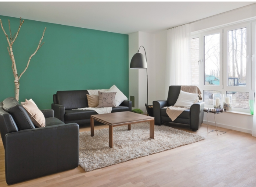
4 Verarbeitet wurden Gipsfaser-Platten »Greenline«, die VOCs (flüchtige organische Verbindungen) aus der Raumluft binden und dauerhaft neutralisieren. Die beplankten Wände erhielten abschließend einen diffusionsoffenen Oberbelag. Fotos 2 – 4: Birgit Schewe
