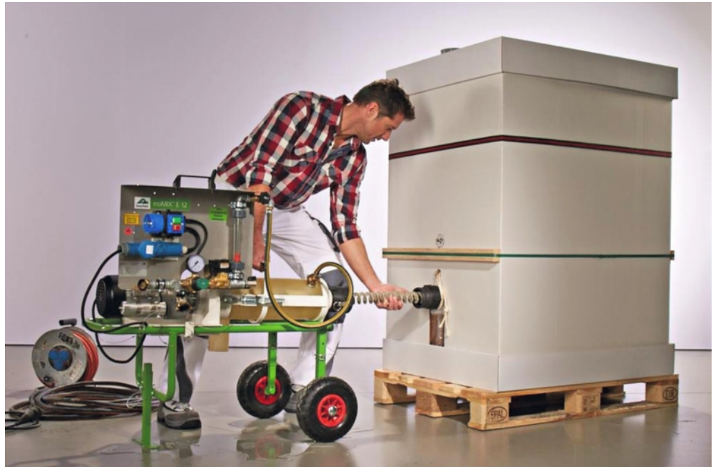
Anschluss der Entnahme- vorrichtung und des Mischers an den Einweg- karton. Foto: DAW
