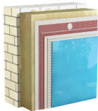
3 Der Systemaufbau: Eine doppelte Armierungsschicht sorgt für die nötige Ebenheit des Klebeuntergrunds.
