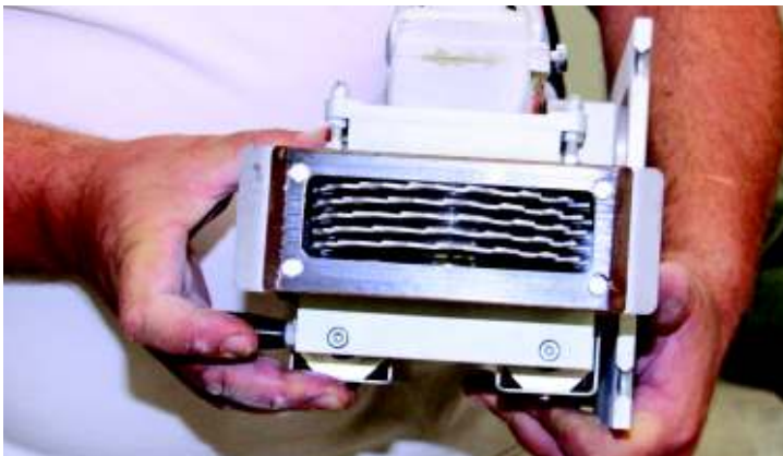
6 Mit parallel laufenden Sägeblättern werden die Platten geschlitzt ...
