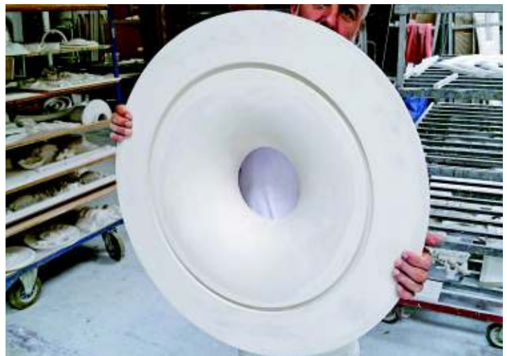
3 Der Fertigmodul-Lampenreflektor aus Stuck ist für die Kombination mit dem Trockenbau vorgesehen.
