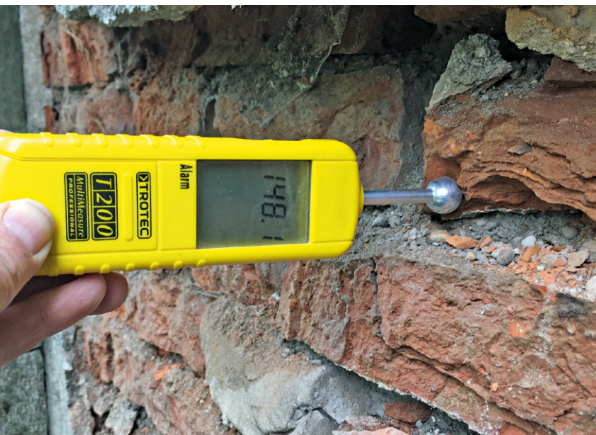
3 Elektrische Feuchtmessgeräte erlauben es sich sehr schnell über den Feuchtegehalt des Mauerwerks zu informieren und die Stellen zu lokalisieren, die für eine Probeentnahme geeignet scheinen. Foto: Baumit
